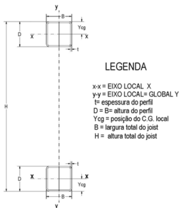
Figura 7 - Seção transversal típica para os banzos – eixos de referência
