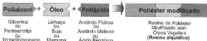
Figura 3.2 - Esquema simplificado de obtenção da resina alquídica
