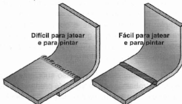
**Figura 4.21** - Evitar sobreposições de chapas, preferir soldas do tipo entalhe
