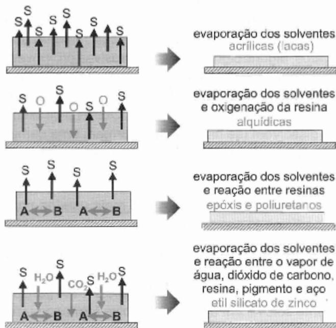
Figura 3.5 - Esquema simplificado de cura das tintas
