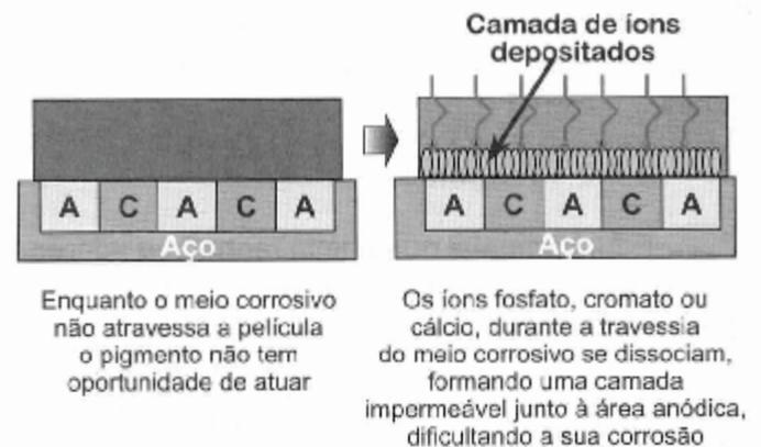
Figura 4.18 - Mecanismo de ação da tinta que atua por proteção anódica
