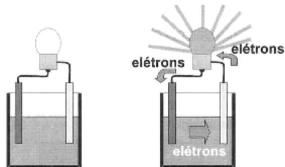
Figura 4.7 - Água destilada é isolante elétrico
