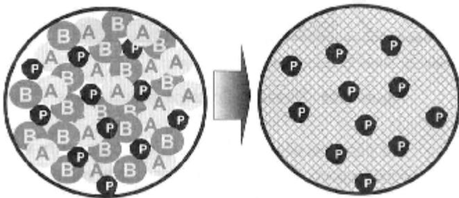
Figura 2.37 - Desenho esquemático mostrando como a tinta em pó cura em temperaturas entre 160 e 190 °C
