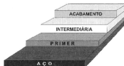
Figura 3.10 - Sistema com primer intermediária e acabamento para ambientes agressivos
