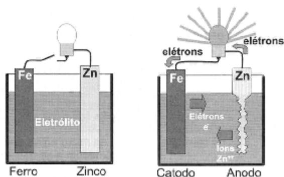
Figura 4.9 - Célula de corrosão eletroquímica
