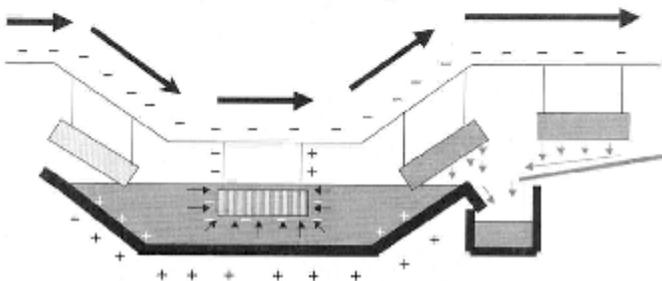
**Figura 2.41** - Sistema de pintura por eletroforese catódica (Cataforese)
