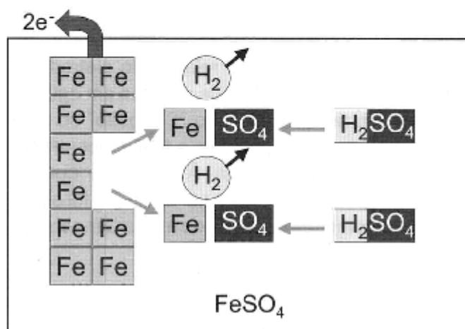
**Figura 4.10** - Corrosão no anodo de ferro em contato com cátodo de cobre e em presença de eletrólito ácido sulfúrico
