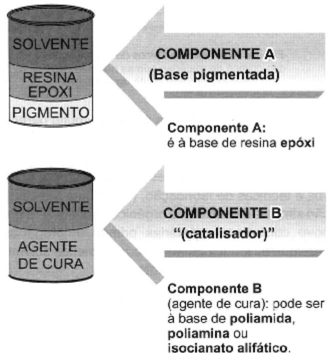
Figura 3.16 - Tintas epóxis
