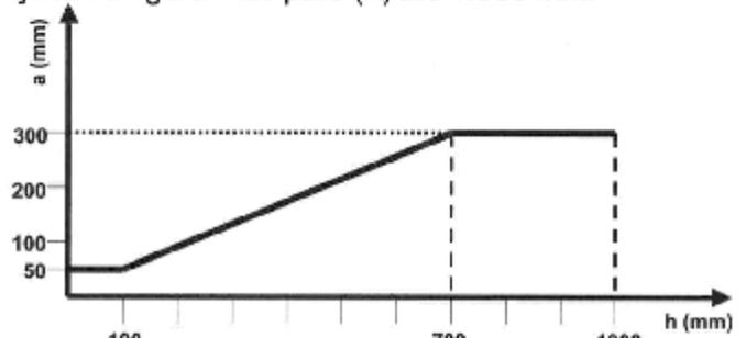
**Figura 4.25** - Distância mínima em função do alcance máximo, em espaços estreitos
