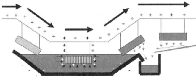
**Figura 2.40** - Sistema de pintura por eletroforese anódica (Anaforese)
