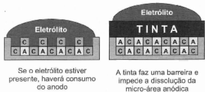
Figura 4.17 - Mecanismo de ação da tinta que atua por barreira
