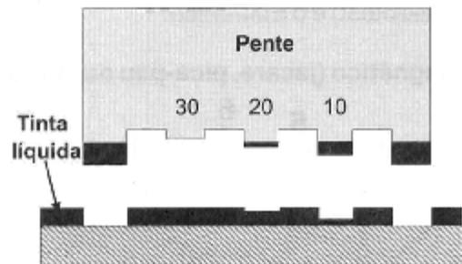
**Figura 2.42** - Medidor de espessura úmida (pente)
