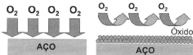
Figura 4.12 - Corrosão do aço em ambiente seco
