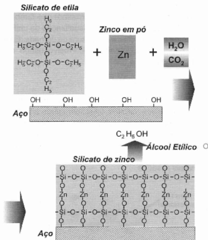
Figura 3.4 - Reação de cura da resina Etil Silicato de Zinco
