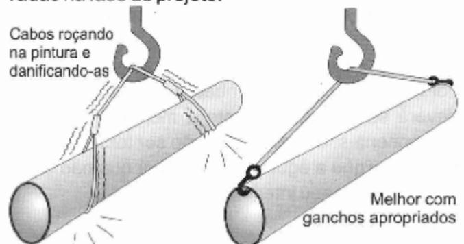
Figura 4.39 - Danos à pintura por transporte inadequado e como melhoras
