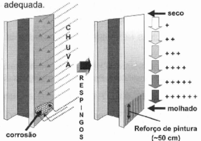
**Figura 4.43** - Desenho demonstrando porque as partes baixas de colunas devem ser reforçadas
