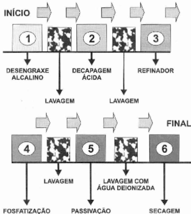
Figura 1.34 - Processo de fosfatização:
