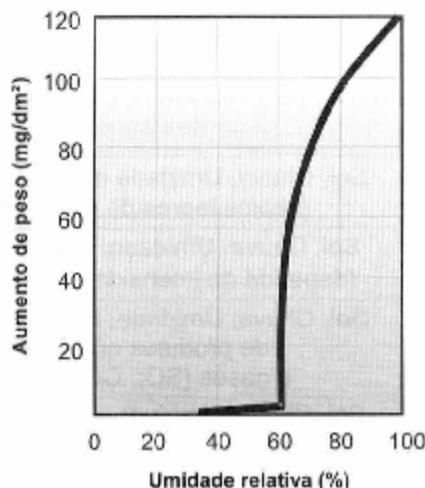
Figura 4.15 - Corrosão do aço em função da umidade relativa contendo 0,01% de SO<sub>2</sub> durante 55 dias de exposição
