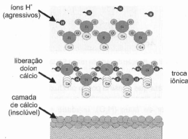
Figura 3.6 - Ação do pigmento anticorrosivo silicato de cálcio
