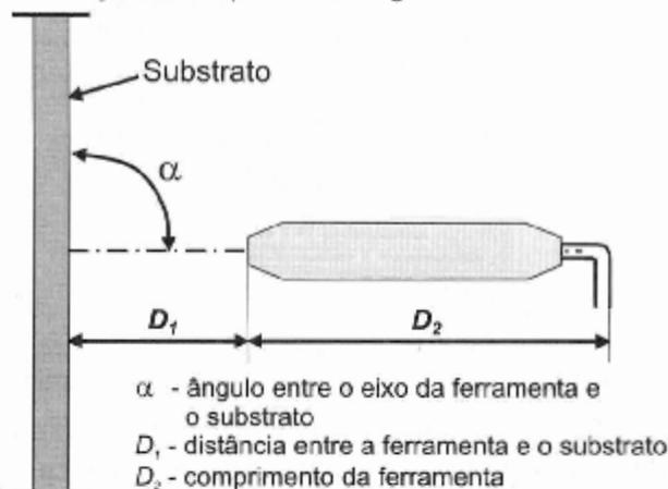
**Figura 4.22** - Medidas recomendadas para preparação de superfície e aplicação de tintas
