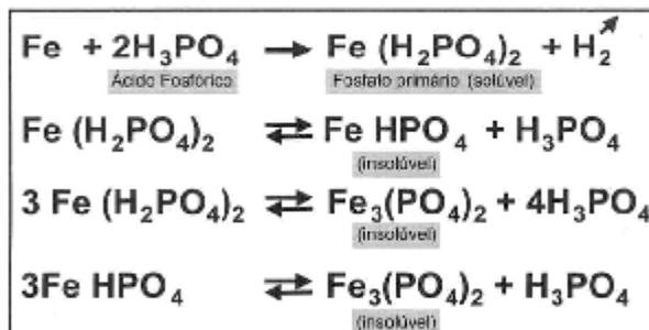
Figura 1.35 - Reações que ocorrem durante a fosfatização
