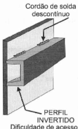
**Figura 4.41** - Cordões de solda descontínuo favorecem a corrosão em frestas
