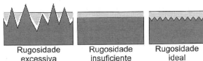
Figura 1.21 - Comparação entre perfis de rugosidade
