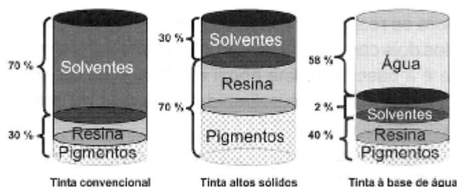
**Figura 3.15** - Valores típicos de participação dos grupos de matérias primas nos três tipos de tecnologias (para efeito de ilustração)
