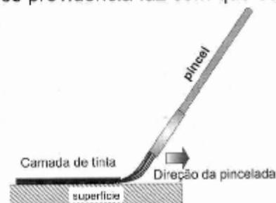
O grande uso dos pincéis na pintura de estruturas metálicas é para reforçar cordões de solda, arestas vivas, quinas, cantos e frestas. No entanto, o reforço nestas áreas deve ser feito com a tinta diluída. A diluição é necessária para possibilitar a penetração da tinta e evitar camadas muito espessas, que acabam sofrendo retração e destacamento. É importante fazer o reforço nestas áreas que são consideradas críticas e isto deve ser feito antes de cada demão normal.
