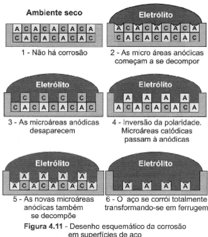
**Figura 4.11** - Desenho esquemático da corrosão em superfícies de aço
