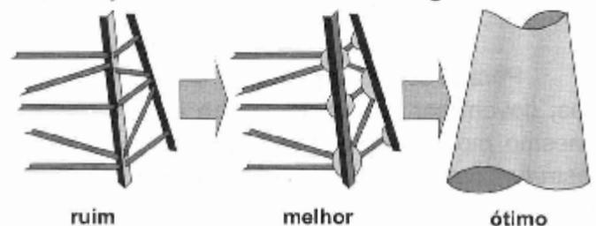
Figura 4.38 - A estrutura tubular é melhor do que a composta por cantoneiras, do ponto de vista da pintura
