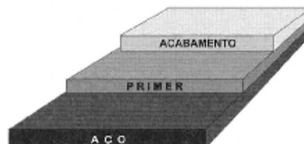
Figura 3.9 - Sistema simples, com primer e acabamento para ambientes de pouca agressividade
