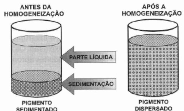
Figura 2.1 - Homogeneização de uma tinta
