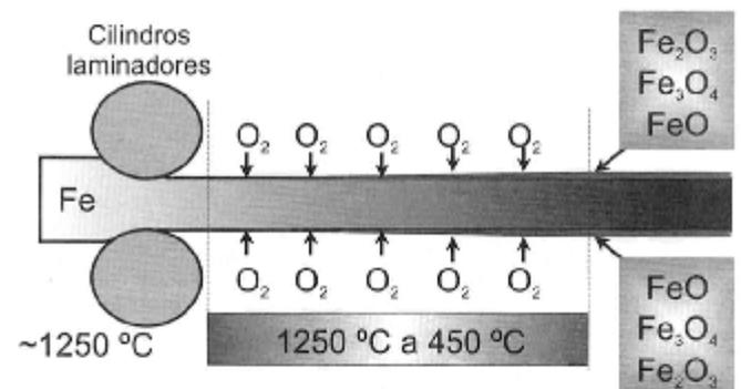
Figura 1.3 - A carepa se forma por reação do oxigênio do ar com o ferro do aço
