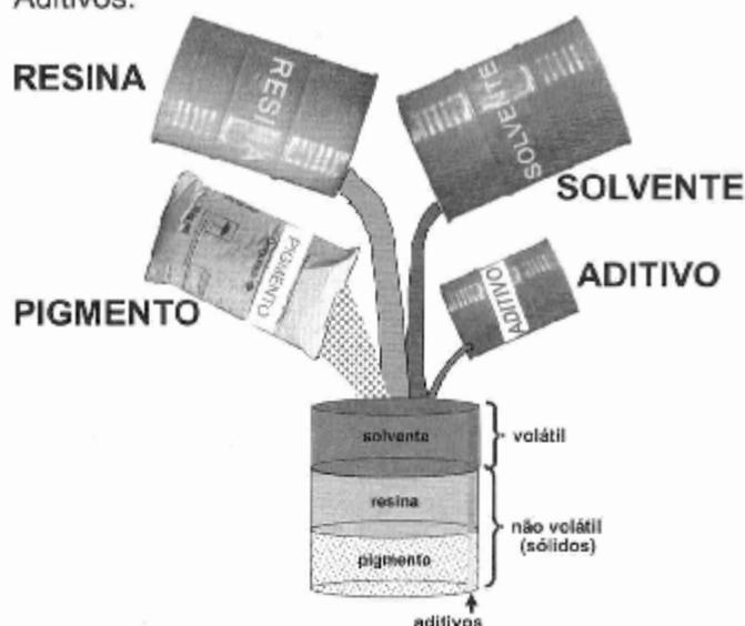
Figura 3.1 - Desenho esquemático da fabricação de tintas com suas matérias primas
