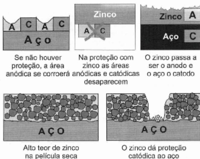
**Figura 4.19** - Mecanismo de ação da tinta que atua por proteção catódica
