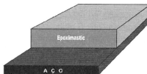
Figura 3.11 - Sistema com tinta epoximastic dupla função e demão única
