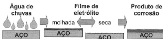
Figura 4.14 - Efeito da alternância entre o molhamento e a secagem da superfície do aço
