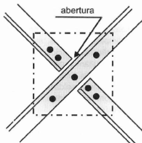
Figura 4.32 - Abertura para escoamento da água
