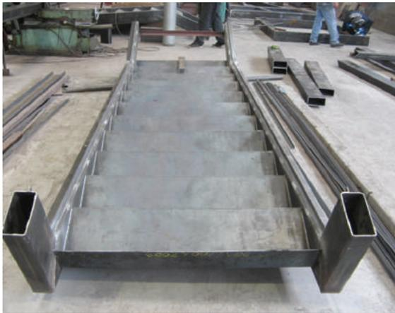
**Figura 2.26: Módulo de escada da residência Pitangueiras pronto para montagem.**
