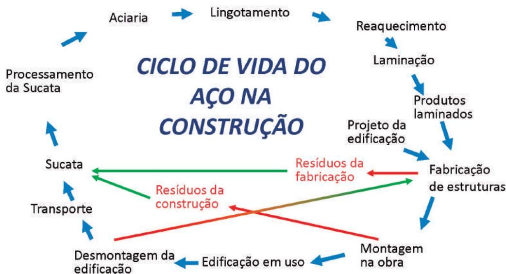
Figura 3.5: Ciclo de vida da estrutura metálica
