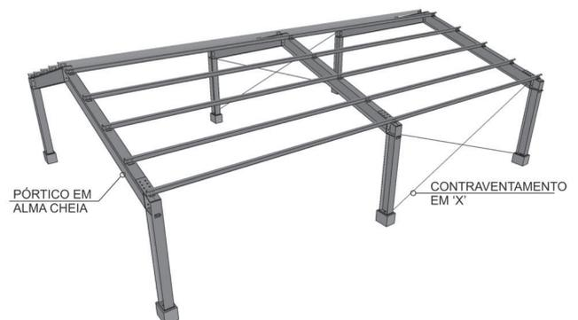
Figura 13 – Edifício industrial de duas águas com perfis I laminados ou soldados
