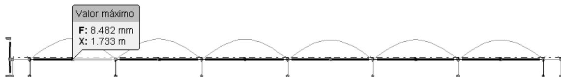
Figura 21 – Deslocamentos na terça de cobertura devido à sucção do vento.
